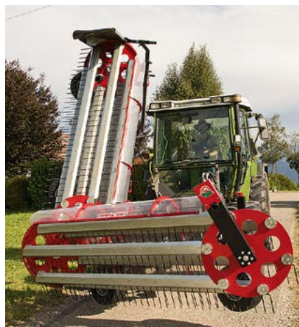
Ungewöhnliche Optik: Die Transportbreite beträgt knapp 3 m, die Höhe weniger als 4 m.
