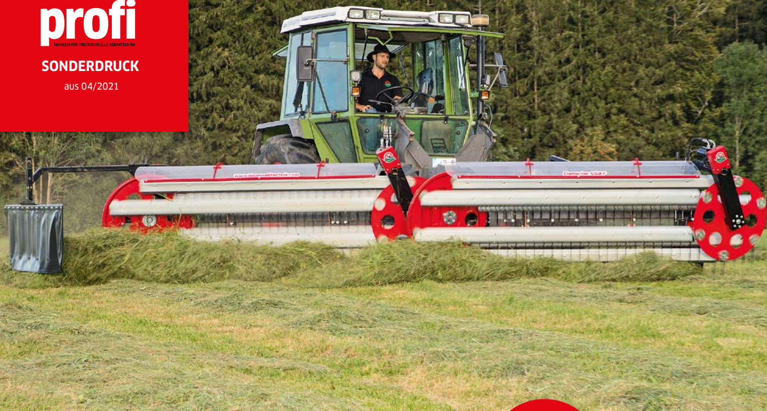
Der Clementer 550 F mit 5,50 m Arbeitsbreite ist aktuell der meistverkaufte Kammschwader von BB Umwelttechnik. Fotos: Zäh
