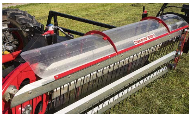
Der Windschutz (Option) aus bruchfestem Makrolon reduziert die systembedingte Windempfindlichkeit des Kammschwaders.
