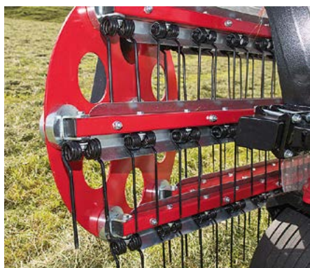
Die äußersten sowie die drei letzten Zinken einer Reihe sind seit 2018 stärker ausgelegt.
