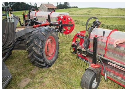
Für einen Soloeinsatz lässt sich das äußere Segment binnen Minuten abbauen.
