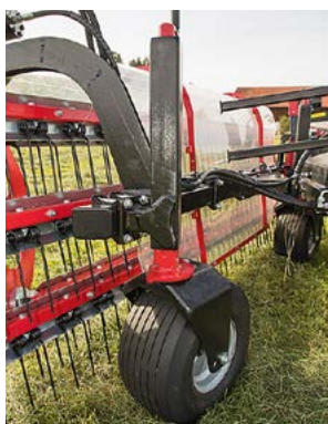
Die breiten Tasträder sind nah am Zinkenträger montiert.
