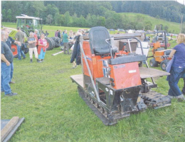
Eine Kuriosität ist der Kubota Reis-Mähdrescher, den Joachim Johr aus Pfronten (l.) importiert hat. Er hat alles abmontiert und benutzt ihn, um Mähgut aus den Streuwiesen zu bergen. Fotos: Rau
