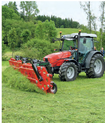
Maschinenbaumeister und Landwirt Max Bannaski (r.) präsentiert seinen selbst konstruierten Kammschwader, den er für die Pflege seiner Moorflächen entwickelt hat. Die waagrecht montierten Zinkenträger rotieren quer zur Fahrtrichtung und schieben das Mähgut langsam zur Seite (M.).
