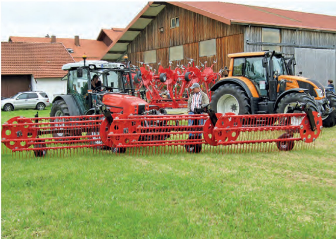
Maschinenbaumeister und Landwirt Max Bannaski (r.) präsentiert seinen selbst konstruierten Kammschwader, den er für die Pflege seiner Moorflächen entwickelt hat. Die waagrecht montierten Zinkenträger rotieren quer zur Fahrtrichtung und schieben das Mähgut langsam zur Seite (M.).
