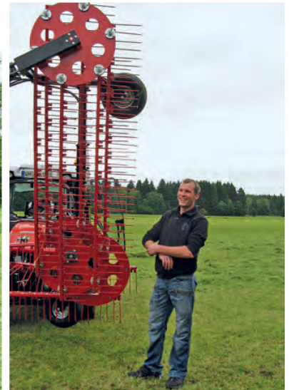
Maschinenbaumeister und Landwirt Max Bannaski (r.) präsentiert seinen selbst konstruierten Kammschwader, den er für die Pflege seiner Moorflächen entwickelt hat. Die waagrecht montierten Zinkenträger rotieren quer zur Fahrtrichtung und schieben das Mähgut langsam zur Seite (M.).
